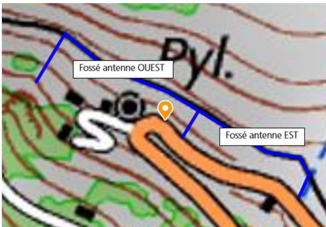
Figure 3 : Schéma de principe des fossés à mettre en œuvre au pourtour de l'arrachement suite à la visite du 04/01/2018
