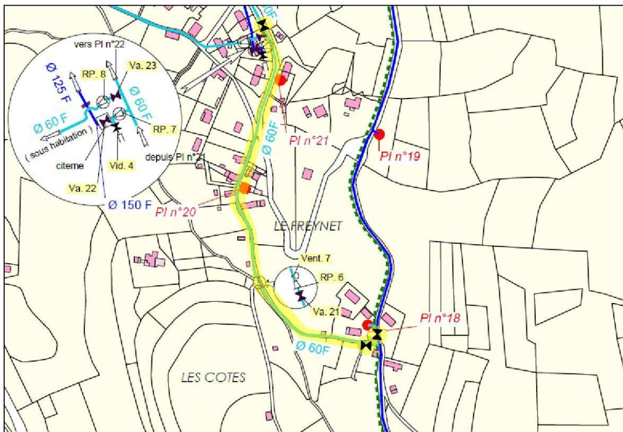
NB : Le renforcement du réseau permettrait de rendre conforme les poteaux incendie n°20 et n°21. Si la défense incendie n'est pas desservie par le réseau de distribution, des cuves dédiées à l'incendie devront être installés dans les secteurs non protégés, soit un coût d'environ 50 000 €HT.
